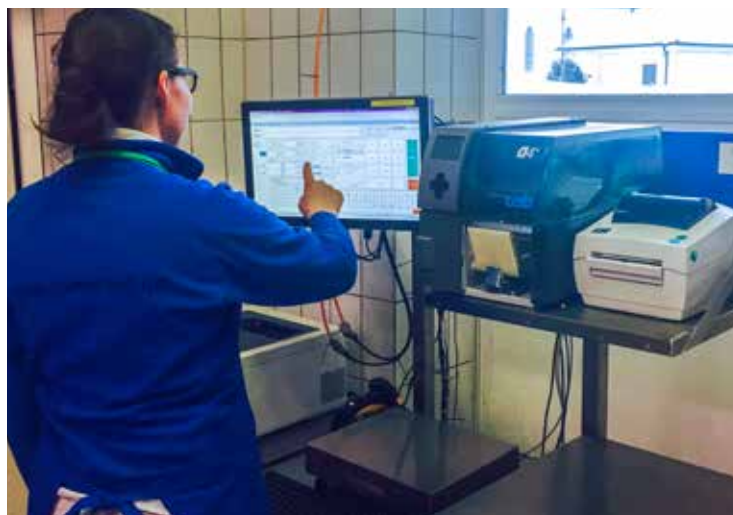
Cleveres Quartett Vernetzt mit Touchscreen-Industrie-PC, Wägebrücke und Etikettendrucker wird APRO.CON zur leistungsfähigen Kommissionier- und Auszeichnungstation.
